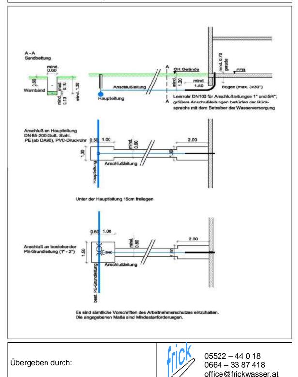
Gegenüber Erdwärmeleitungen sind <u>ALLSEITIG</u> 1,2 m Abstand einzuhalten. Bei Kreuzungen ist eine evtl. Isolierung mit dem Betreiber der Wasserversorgung zu klären.
